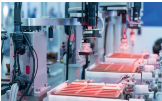
生産ラインで同時に複数のカメラモジュールを校正
